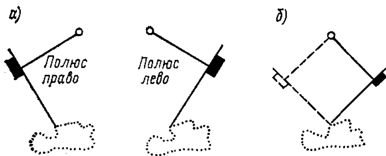
Рис. IV.26. Взаимное положение рычагов планиметра (а) и его изменение при измерении площади участка (б)
